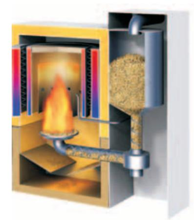
Kleiner Pelletofen mit integriertem Pelletvorrat
