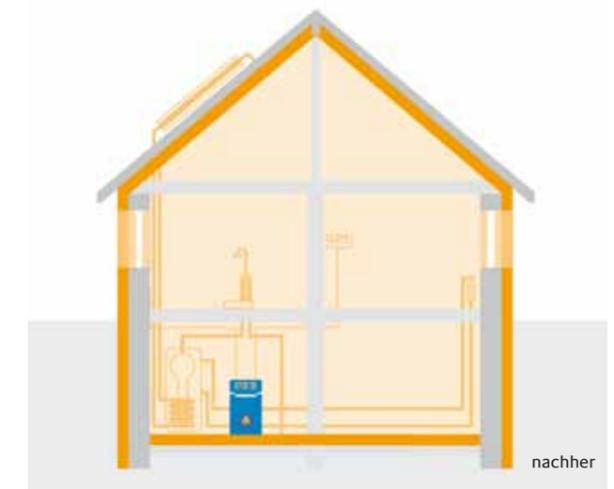
Heizungsleistung und Wärmedämmung: Nach einer umfassenden Wärmedämmung des Gebäudes wird nur noch eine geringere Kesselleistung benötigt.
