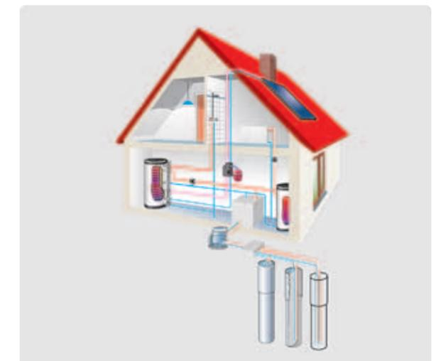
Wärmepumpe und Erdwärmesonden
