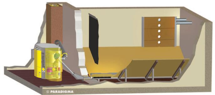
Bei hochwertigen Anlagen steuert eine digital-elektronische Überwachung das optimale Verhältnis von Verbrennungsluft und Pelletmenge. Dies führt zu einem exakt abgestimmten Verbrennungsvorgang mit geringen Emissionen und hohen Wirkungsgraden von bis zu 95%. Verschiedene Rückbrandsicherungen sorgen zusätzlich für einen gefahrlosen Betrieb der Anlage.
